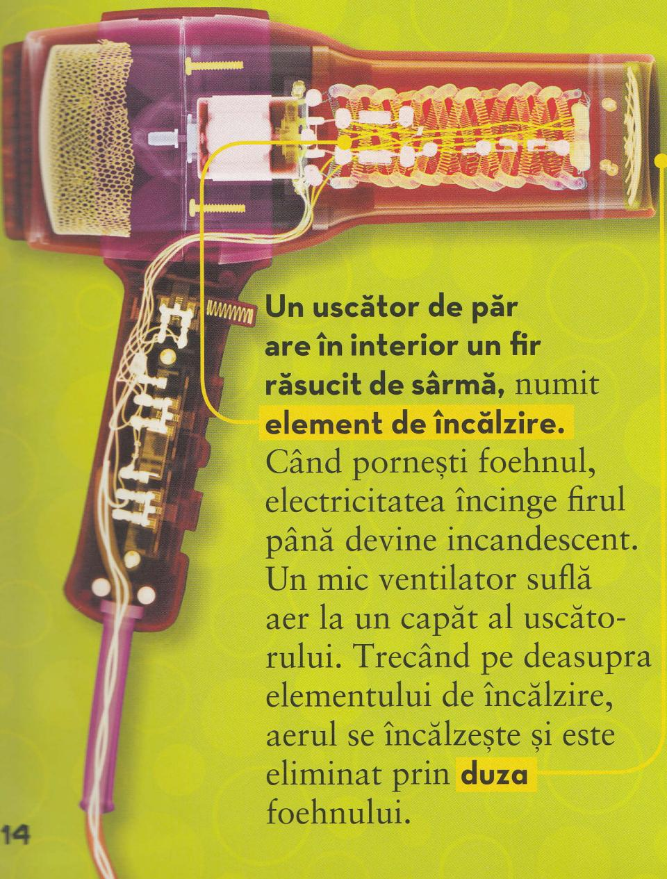
**Un uscător de păr are în interior un fir răsucit de sărmă, numit element de încălzire.**
